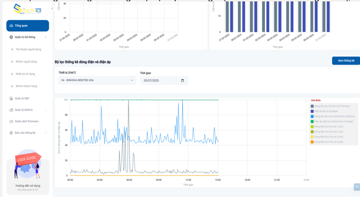
Hình 18. Thống kê bằng biểu đồ giá trị điện áp và dòng điện của các module trong thiết bị
